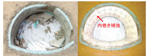
(a) 補強なし (b) 補強あり
