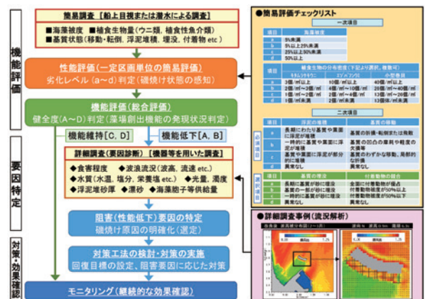
図-14.12 藻場創出機能評価のための機能診断
