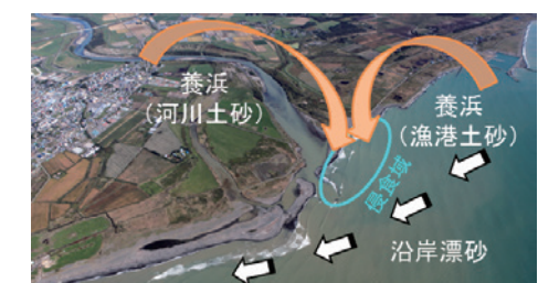
図-11.8 河口地形の安定化に有効な養浜手法の概略図
