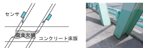
目視困難な部位の例（コンクリート埋込部の橋梁部材の腐食） 周波数を変えた波を送信、遮断周波数より残存板厚を計測
