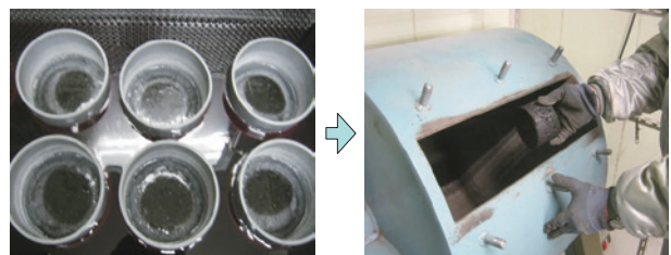
凍結・融解行程 5°Cカンタプロ試験 図-14.7 凍結融解作用に対する性能評価試験
