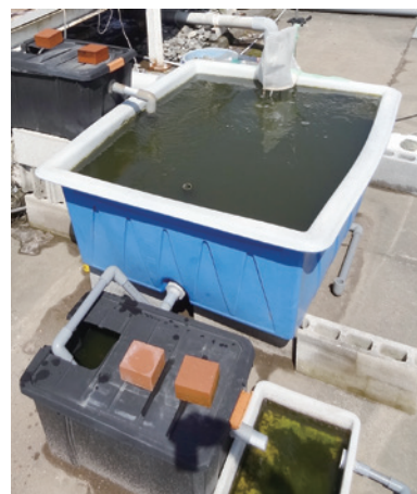
藻類を活用した下水処理法の実証装置
