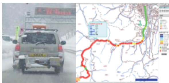
図-16.2 連続路面すべり抵抗値測定装置(CFT)およびモニタリング結果の例
