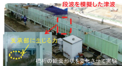
図-3.5 津波作用の検討のための実験装置
