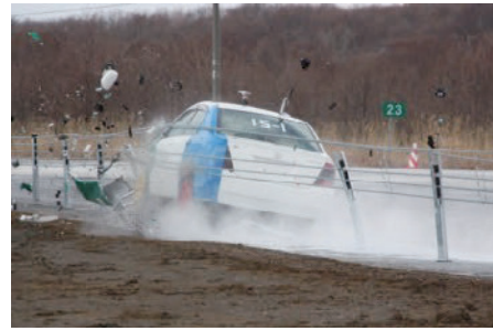
図-16.10 連結材性能確認試験
