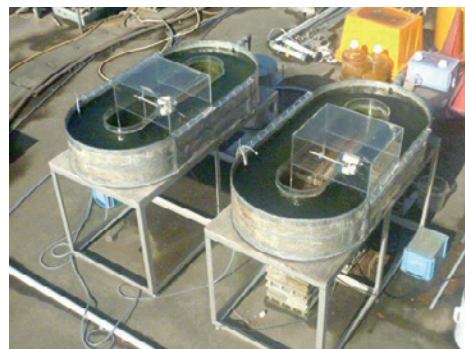
図-6.5 380L水槽による藻類の屋外培養実験
