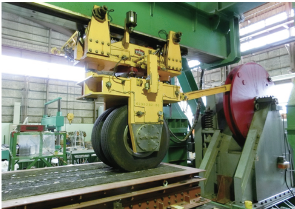
写真-8.1.1 輪荷重走行試験機の使用状況（寒地土木研究所第3実験棟）
