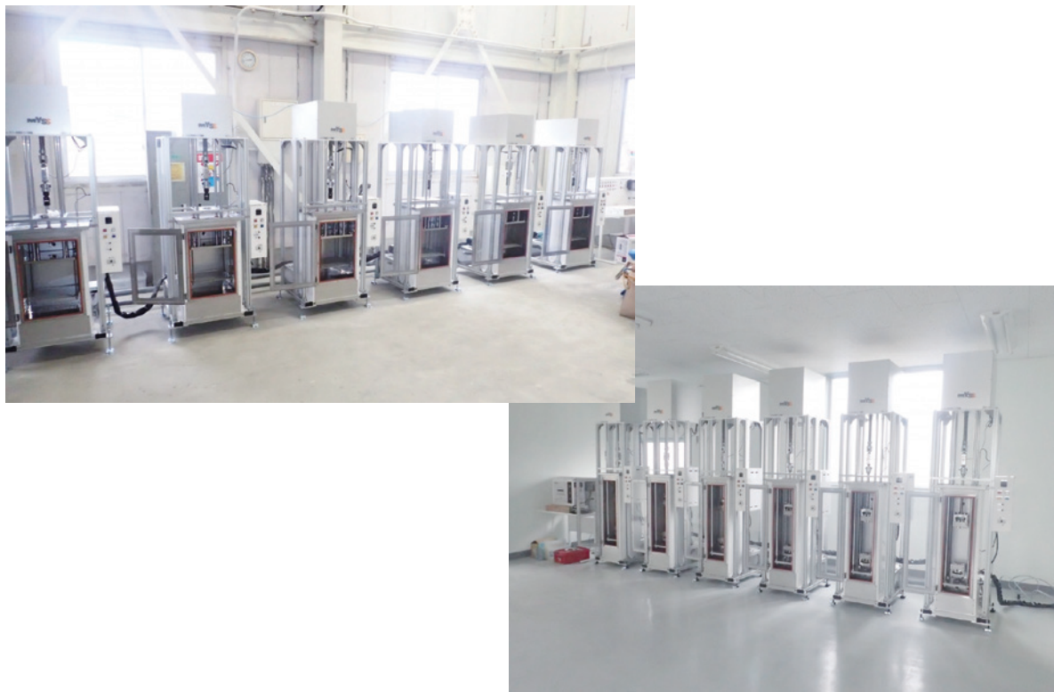
写真 -8.1.5 クリープ試験機(上:コンクリートアンカー用、下:ゴム用)
