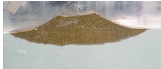
500gal 加振後の変形（無対策）
