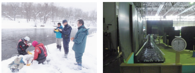
図：真勲別頭首工における現地調査（左）およびアイスジャム水理模型実験（右）
