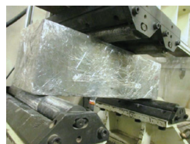
曲げ疲労試験状況
