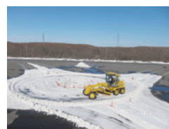
モーターグレーダによる除雪作業
