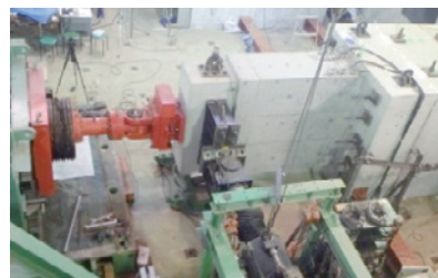
高強度鉄筋を用いた RC 巻立て補強された壁式橋脚模型の正負交番載荷実験
