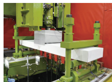
扁平 RC 梁の衝撃载荷実験状況
