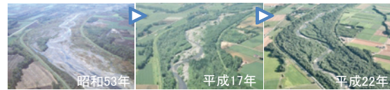
樹林化と流路固定化（札内川）
