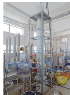
散水ろ床実験装置の外観
