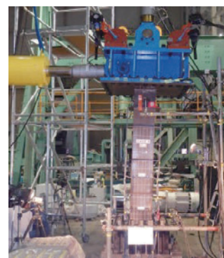
鋼部材の正負交番荷重実験
