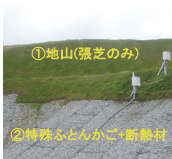
断熱材を併用した特殊ふとんかごの試験施工
