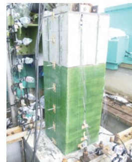
埋込み軸方向鉄筋補強と繊維材巻立てを併用した橋脚模型の正負交番載荷実験
