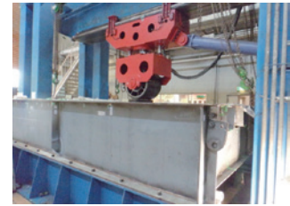
輪荷重走行試験状況
