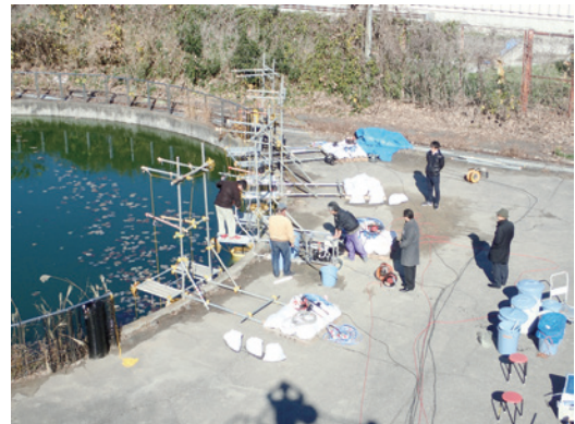
大水深凝集沈殿実験の様子
