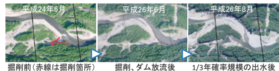
掘削による旧流路への分岐流の回復
