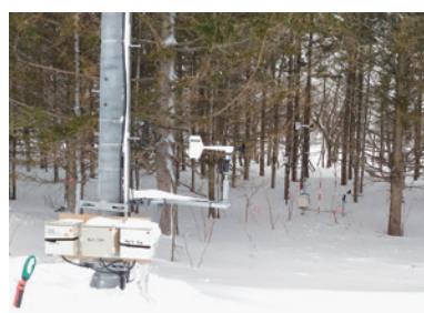
図 防雪林内での風速の観測状況
