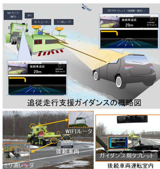
図-13 追従走行支援ガイダンスによる実験状況
