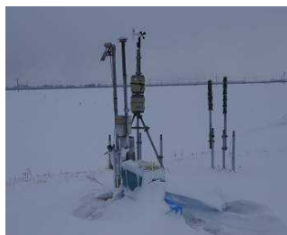
写真-1 気象観測機器の設置状況（青森県）
