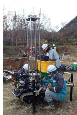
図-8 自走式静的貫入装置
