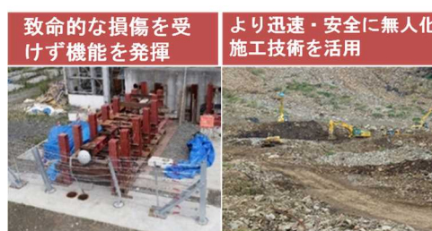
図-3 土砂災害の防止・軽減のための開発技術（左：落石防護柵の載荷実験，右：阿蘇大橋地区
