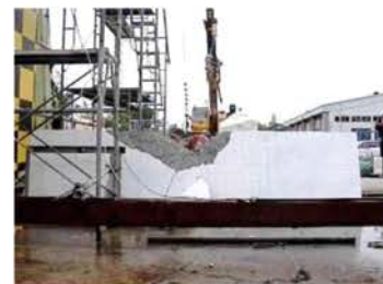
図-8 落石防護施設の衝突実験
