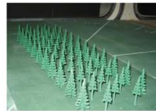
図-9 縮小模型による防雪林の風洞実験
