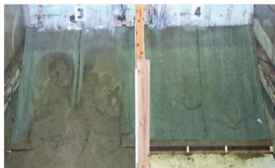
時間雨量 100 mm・4 時間でのり面状況 (左：ケース3、右：ケース4)
