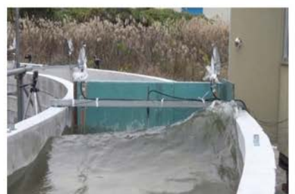
図-4 河川津波遡上実験による構造物への影響把握
