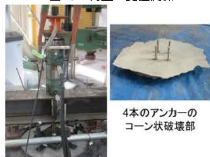
図-9 複数のアンカーの載荷試験とコーン状破壊部の状況
