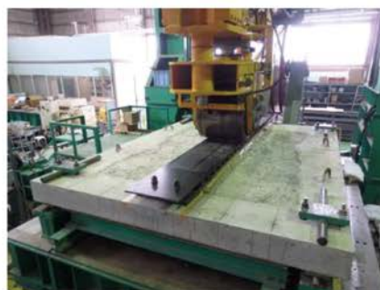
写真-3 撤去床版の疲労载荷試験の状況
