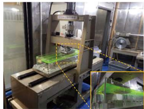
写真-4 新たに開発した水中摩耗試験機
