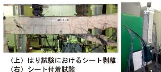
図-10 シート補強試験体の試験状況
