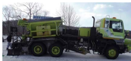
図-3 フレームが破断し、老朽化が著しい除雪機械
