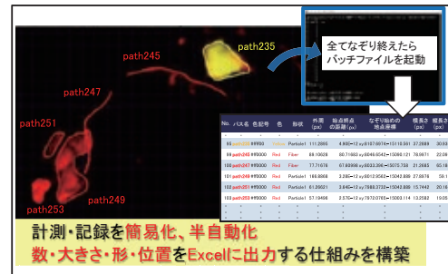
マイクロプラスチック観察データの計測手順の簡易化・半自動化の概要
