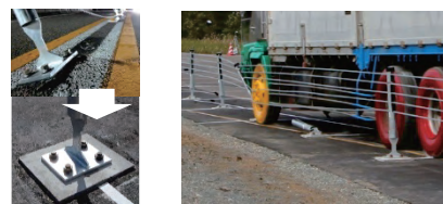
図-10 中小橋梁への新たな固定方式(左)と衝突実験(右)
