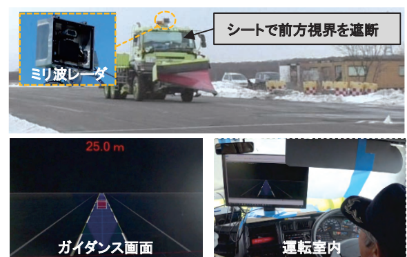
図-10 前方障害物探知ガイダンスによる実験
