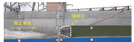
図-2 浸透模型実験で確認された崩壊の進行
