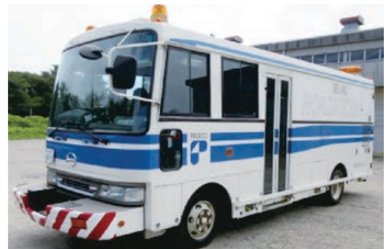
写真-1 移動式たわみ測定車（MWD）構造調査
