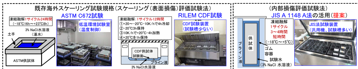
図-1 各試験方法における凍結融解試験条件と試験機器の概要
