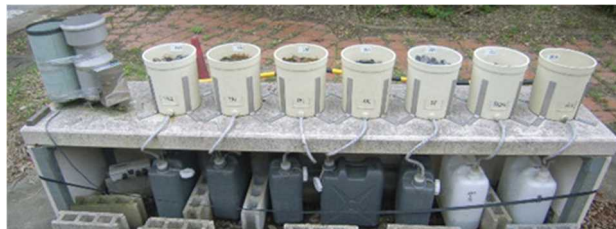
図-8 土研式雨水曝露試験の実施状況
