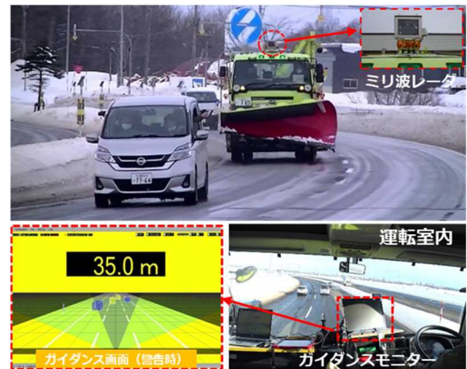
図-13 前方障害物探知ガイダンスの一般国道における実験状況
