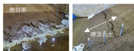
図-9 大型模型実験における破壊形態の変化
