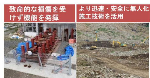
図-3 土砂災害の防止・軽減のための開発技術（左：落石防護柵の荷重実験，右：阿蘇大橋地区）
