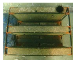
図-9 コンクリート製試験礁の概要
