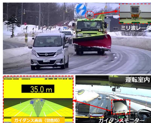
図-13 前方障害物探知ガイダンスの一般国道における実験状況
