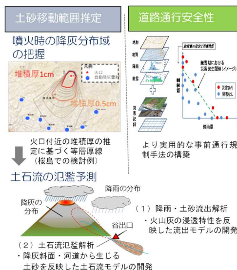
図-2 土砂移動の範囲推定技術及び道路通行安全性確保技術
