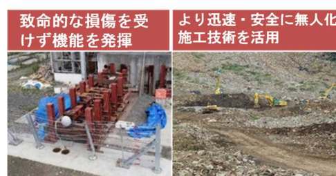
図-3 土砂災害の防止・軽減のための開発技術（左：落石防護柵の荷重実験，右：阿蘇大橋地区）
