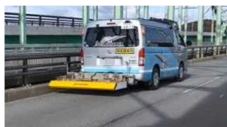
写真-1 車載式電磁波レーダー計測
