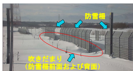
図-4 石狩吹雪実験場での計測状況
