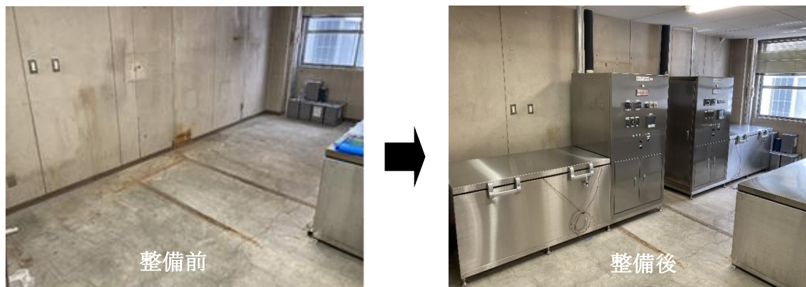
写真-8.1.1.2 凍結融解試験装置整備（寒地）
