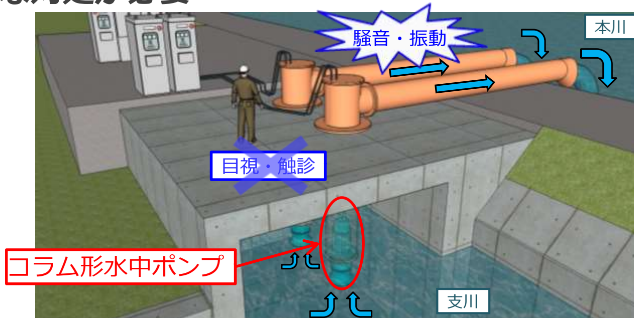
▲コラム形水中ポンプの設置概要図
