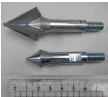
土層強度検査棒（どけん棒）の構成
