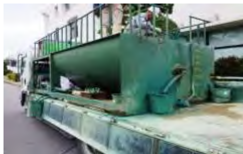
吹付工用ポンプ車
