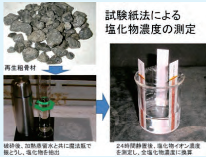
破砕後、加熱蒸留水と共に攪拌瓶で振とうし、塩化物を抽出
