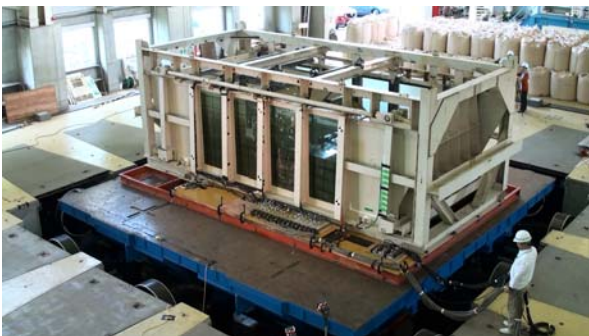
写真-1 大型振動台と大型剛土槽
