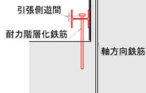
軸方向鉄筋及び補強鋼板が作用しつつも、橋脚に限定的な損傷が発生することは許容。
