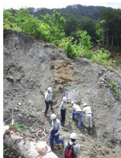
で行われました。当センターからは、畠田と木村が参加しました。濁沢地すべりは地すべり土塊が長距離移動したものであり、今回の調査では地すべり土塊が長距離移動した機構を明らかにするために、斜面の断面にトレンチを掘り、地すべり土塊の特徴などを詳しく調べました。
