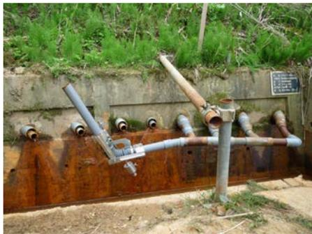
写真1 集水管閉塞防止器の現地試験
