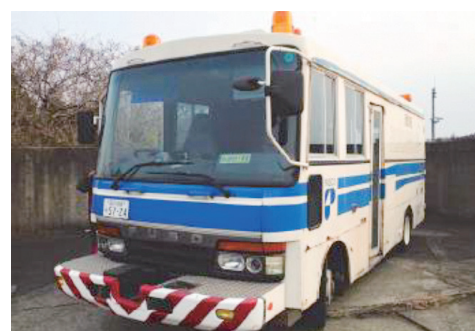
写真－ 3.1.7 移動式たわみ測定装置
