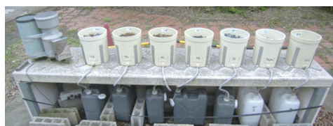
図－4.2.10 土研式雨水曝露試験の実施状況
