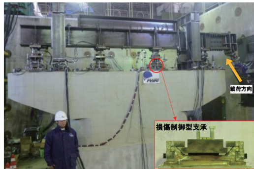
写真- 2.1.6 橋脚-支承系における損傷
