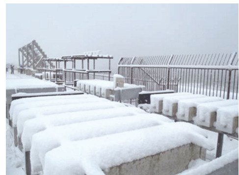
写真－3.1.9 ひび割れ試験体暴露試験（留萌暴露実験場）
