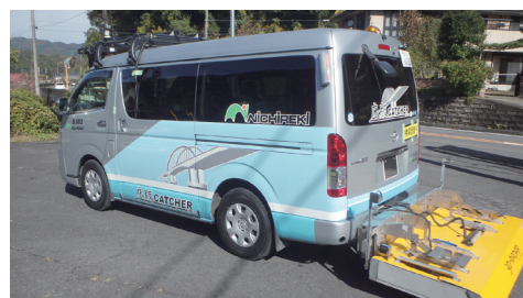
写真－ 3.1.4 車載式電磁波レーダ
