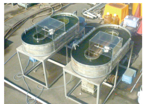
図-4.1.2 藻類培養装置の例（レースウェイ式藻類培養装置）
