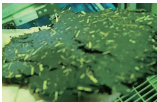
図-4.1.8 脱水助剤(刈草)を混合した脱水ケーキ
