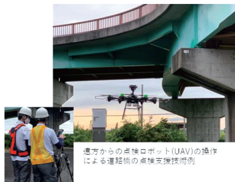
写真－ 3.1.2 UAV の取得画像の処理に点検 AI（画像解析）を活用
