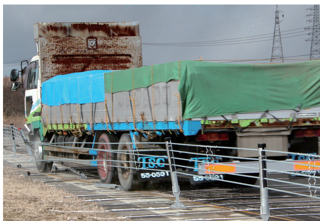
写真－4.5.3 大型車衝突試験
