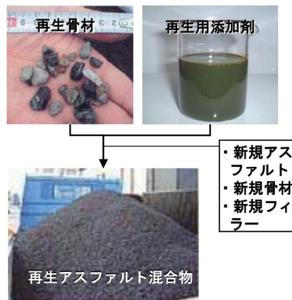
図-4.2.4 再生アスファルト混合物の原材料
