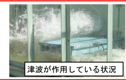
写真- 2.1.3 大型実験水路を用いた津波による橋の挙動検討実験
