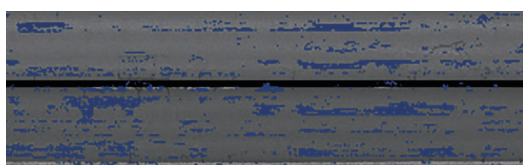
図－ 3.1.3 床版上面滞水推定結果
