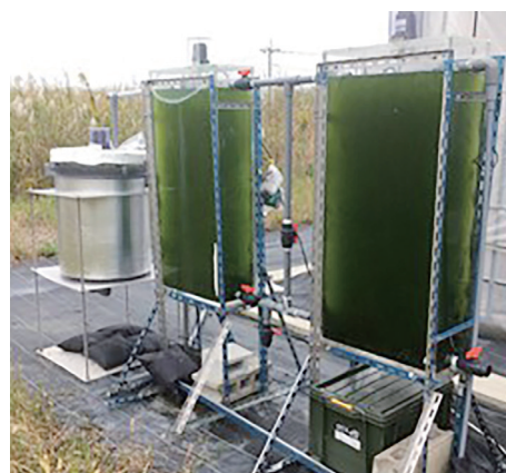
写真－7.1.2 下水を利用した藻類の 培養実験
