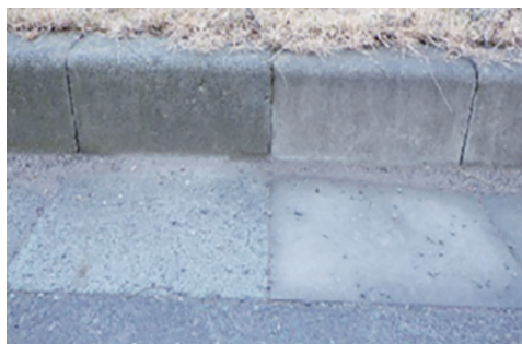
図-4.2.2 図(写真)10年間屋外暴露されたコンクリート製品 (左側は天然骨材、右側は再生骨材使用)
