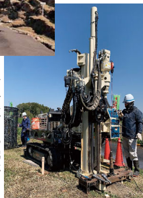
原位置液状化試験法「振動式コーン試験」
