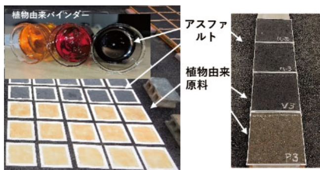
植物由来の舗装用代替材料の屋外暴露例
