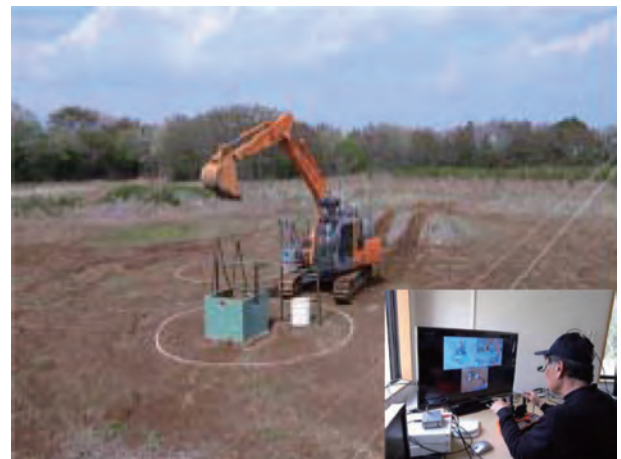
写真 - 2.1.1.1 遠隔操作実験状況
