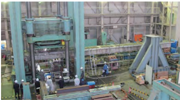
(b) 塩害を受けたPC桁の荷重試験 (供用中に桁端部付近で著しい塩害が見られた支間20mのPC桁のせん断耐力を調査した。)
