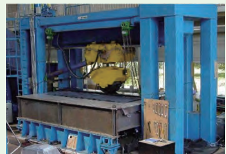
鋼床版試験体を用いた疲労試験
