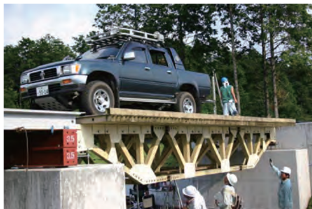
写真- 2.1.2.4 実大 FRP 応急橋の載荷試験
