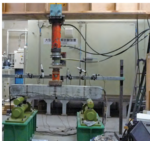
写真-2.2.3.5 凍害劣化RC梁の載荷試験
