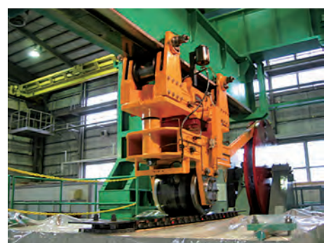
写真-2.2.2.11 輪荷重走行試験機
