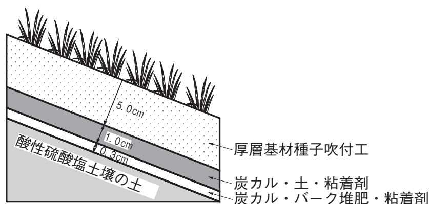
図- 2.2.6.1 中和工法断面模式図
