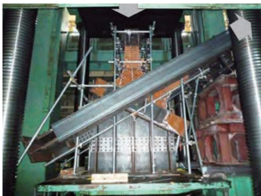
写真－ 2.4.5.3 撤去トラス部材の載荷試験の状況 (格点部を治具に固定し、二軸載荷)
