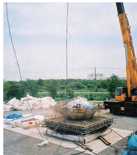
写真-2.2.2.4 緩衝構造に関する屋外大型実験状況
