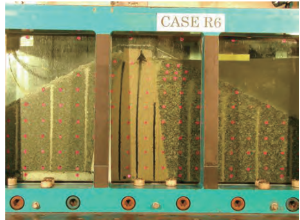
写真-2.1.5.3 フィルダムの大型遠心力载荷試験
