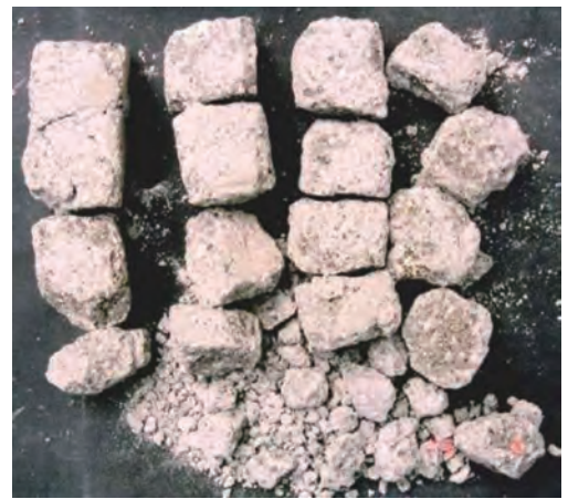
写真-2.1.34 濁沸石によって劣化・破壊した曝露供試体
