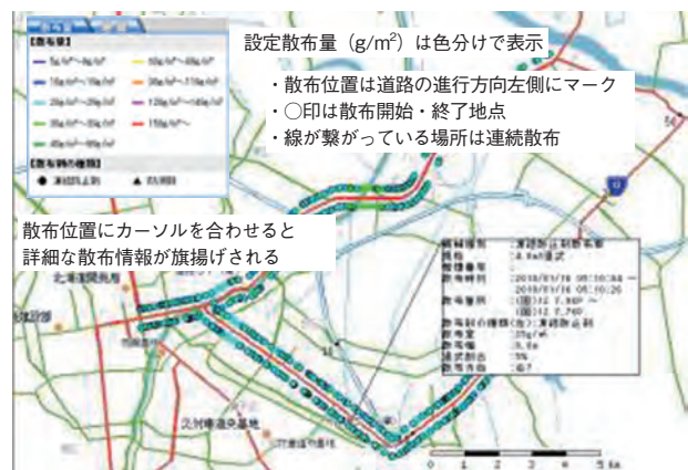
図-2.2.1.4 散布情報収集・管理システム
