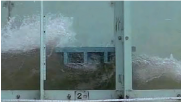
写真 - 2.4.5.6 津波の作用と橋の挙動に関する水路実験
