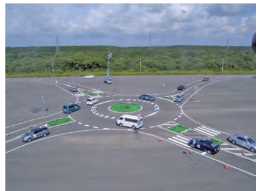
写真-2.2.5.8 模擬ラウンドアバウトでの走行試験
