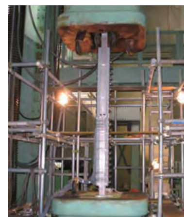
図- 2.4.5.12 12 列の高力ボルト継手のすべり耐力試験
