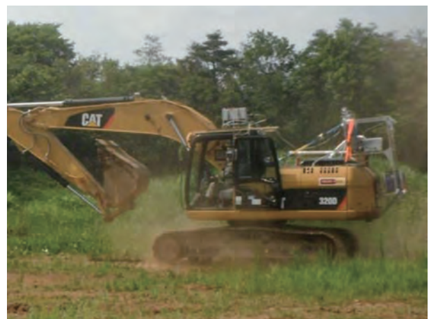
写真-2.1.1.3 車載型排気ガス測定装置
