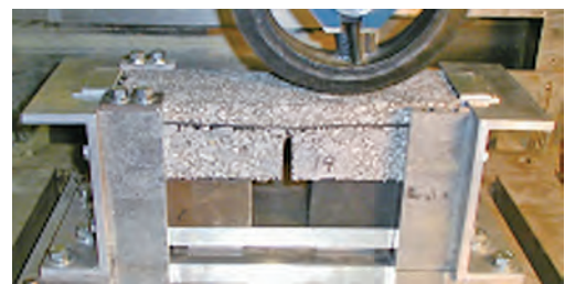
写真-2.2.3.15 補修工法の耐久性試験
