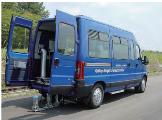
図-2.1.7.5 衝撃式たわみ測定車
