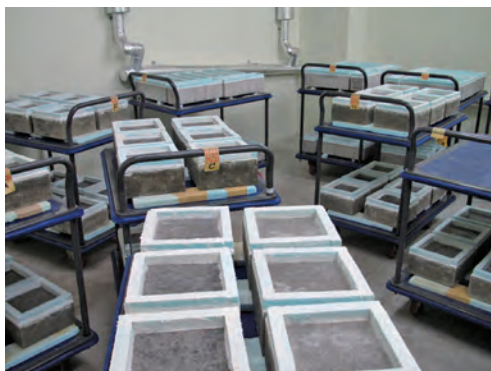
写真-2.2.3.10 ASTM C 672によるスケーリング試験
