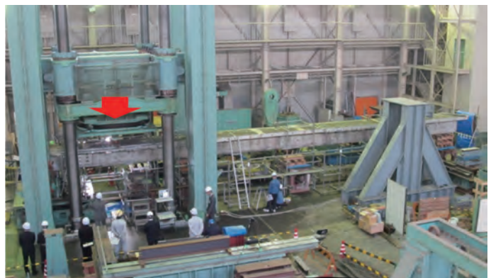
写真－ 2.4.5.4 撤去 PC 桁の載荷試験の状況
