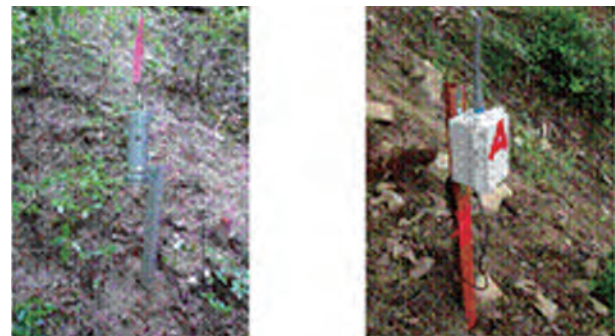
写真-2.1.6.3 斜面崩壊検知センサー
