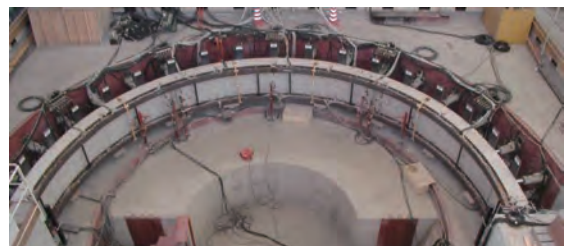
写真-2.1.7.1 覆工載荷実験の写真
