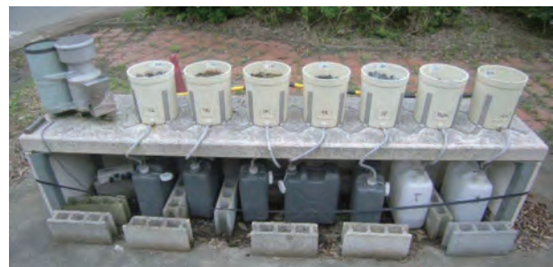
写真-2.1.3.3 土研式雨水曝露試験装置
