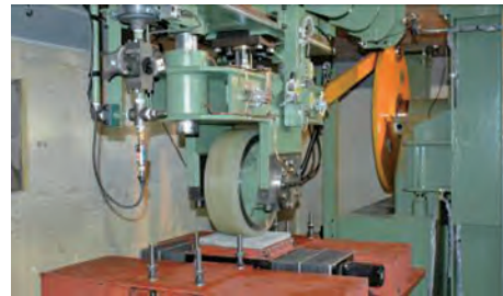
写真-2.2.2.13 凍害用ランダム走行試験機
