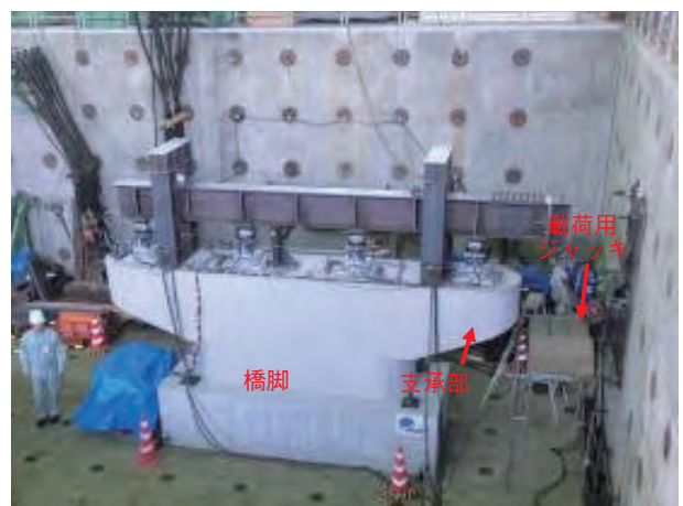
写真-1.5.3 津波の影響に対する支承部の抵抗特性に関する実験の状況
