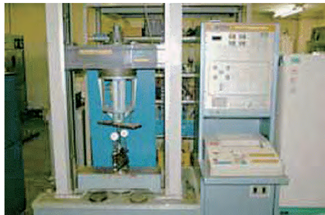
写真-2.2.3 圧裂試験装置
