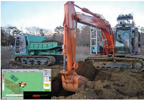
写真-3.3.4 建設機械の自動制御技術の研究
