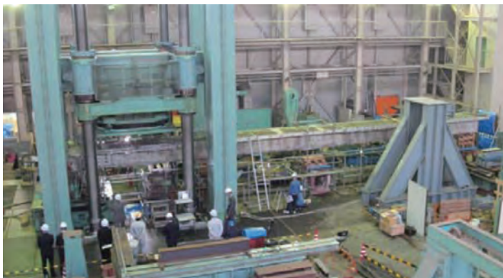
(b) 塩害を受けたPC桁の載荷試験 (供用中に桁端部付近で著しい塩害が見られた支間20mのPC桁のせん断耐力を調査した。)
