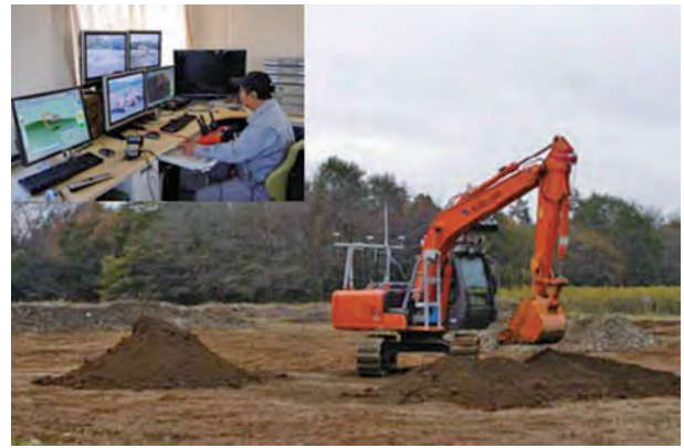
写真-3.3.5 建設機械の遠隔操作技術
