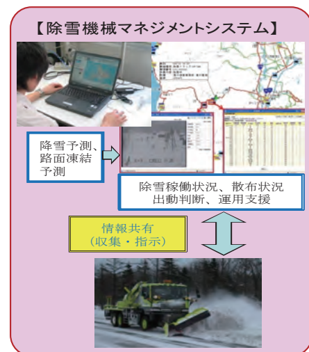
図-2.2.1.2 ICTを活用した除雪作業の効率化
