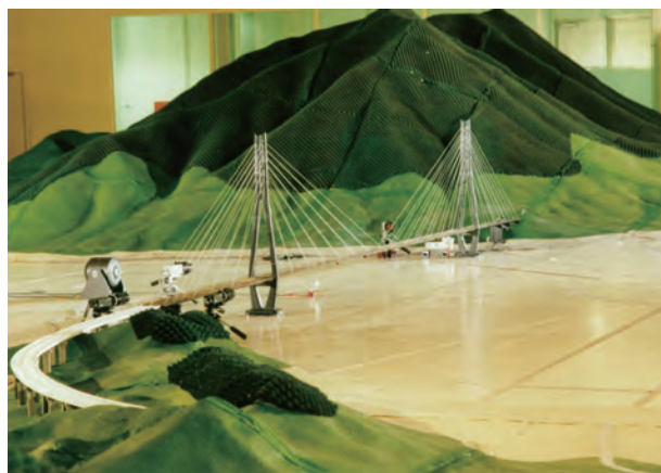
写真-3.1.4 多々羅大橋の全橋模型試験 (写真提供：本州四国連絡高速道路（株）)
