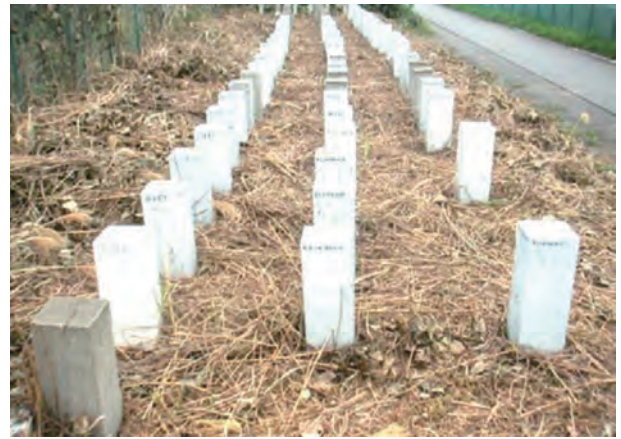
写真-2.1.2.2 ASR抑制対策確認のための長期暴露試験
