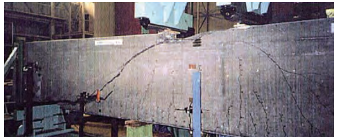
写真-2.1.2.7 高強度コンクリート PC 梁供試体の載荷試験状況
