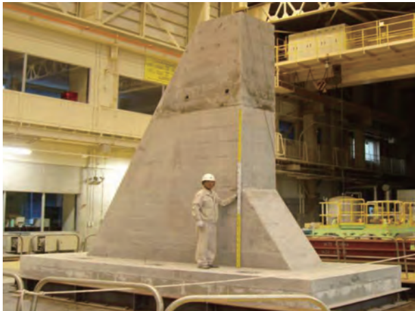
写真-2.1.5.2 三次元大型振動台を用いた大型試験体によるクラック進展試験
