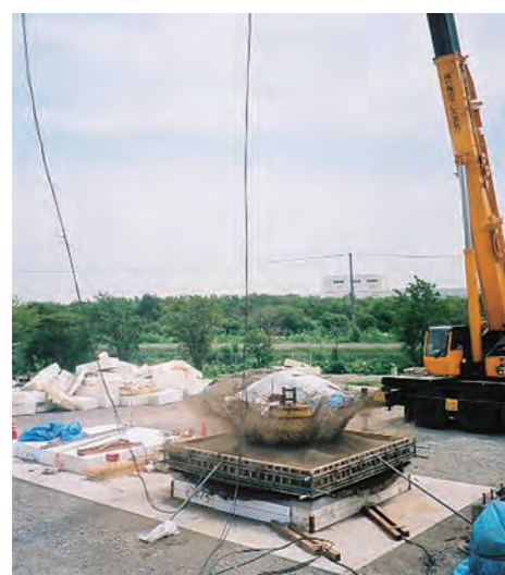
写真-2.2.2.4 緩衝構造に関する屋外大型実験状況
