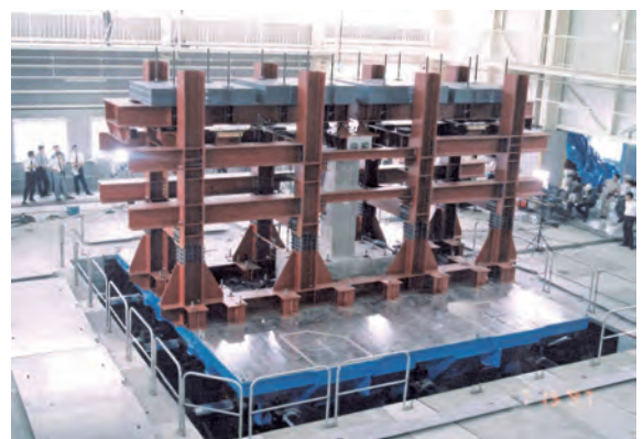
写真-1.1.3 RC橋脚に対する振動台実験
