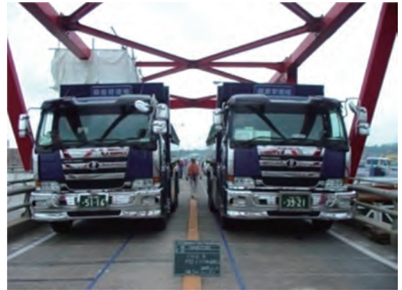
(a) 腐食劣化した鋼トラス橋の載荷試験 (腐食劣化により断面欠損が生じた鋼橋の活荷重に対する挙動を調査した。)
