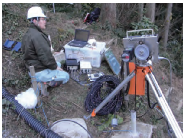
図-2.1.6.15 加熱式地下水検層実施状況
