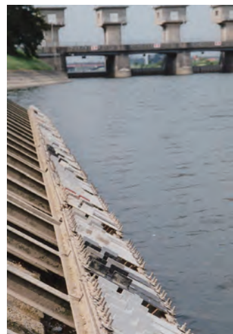
写真-3.3.8 江戸川水門での暴露試験
