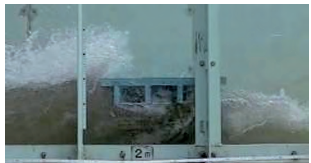
写真-1.5.2 津波の作用と橋の挙動の観測
