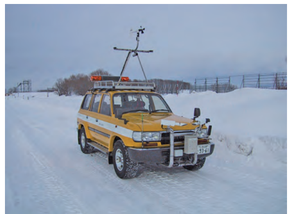
写真- 2.2.5.10 視程障害移動観測車
