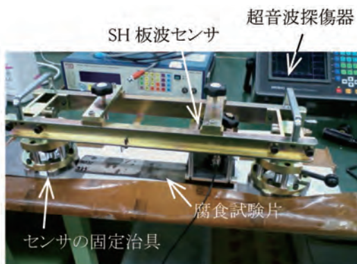
写真- 2.4.5.10 鋼材の腐食減肉量の計測への超音波探傷法の適用性検証
