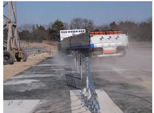
写真-2.2.5.7 緩衝型ワイヤーロープ式防護柵の衝突実験
