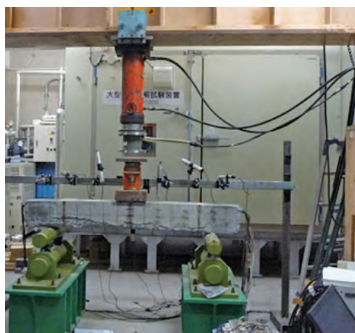
写真-2.2.3.5 凍害劣化RC梁の載荷試験
