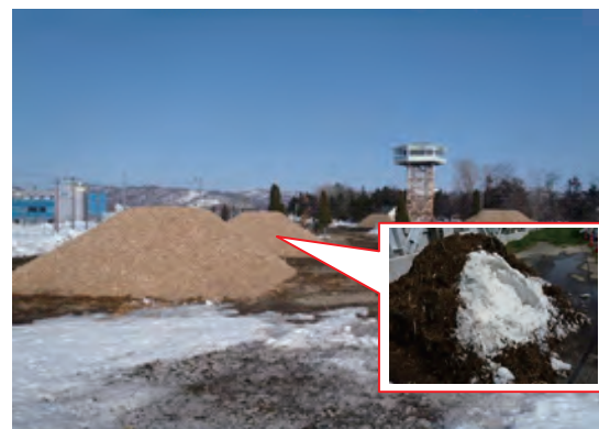
写真- 2.2.1.3 実験用雪山の造成 (断熱材にバーク材を使用)
