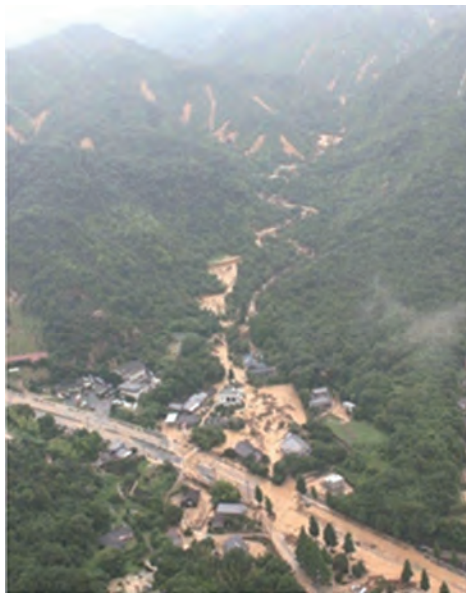
写真－2.1.6.4 平成 21 年 7 月に山口県防府市で発生した土砂流。複数流域から流下した土砂流が合流して下流で氾濫している
