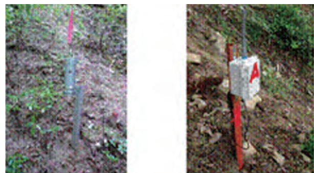
写真-2.1.6.3 斜面崩壊検知センサー
