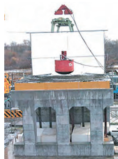
写真-2.2.2.5 1/2 覆道模型を用いた衝撃実験状況
