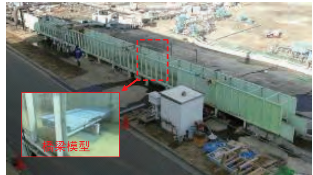
写真-1.5.1 橋梁模型の水路実験の状況
