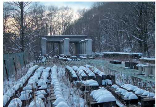
写真- 2.2.3.11 美々凍害実験場 (旧十勝大橋の桁)
