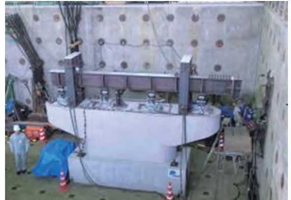
写真－ 2.4.5.7 津波の影響に対する支承部の抵抗特性に関する実験
