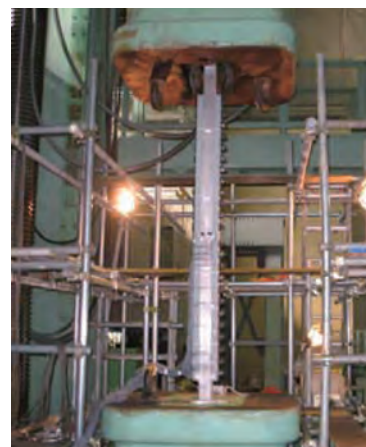
図- 2.4.5.12 12 列の高力ボルト継手のすべり耐力試験
