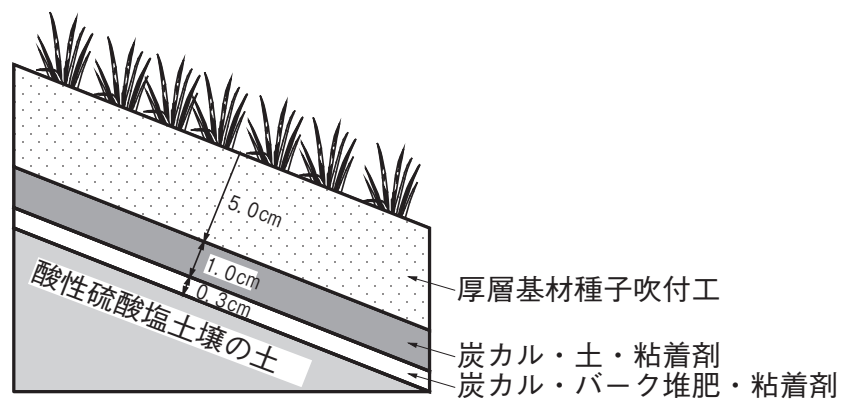
図- 2.2.6.1 中和工法断面模式図
