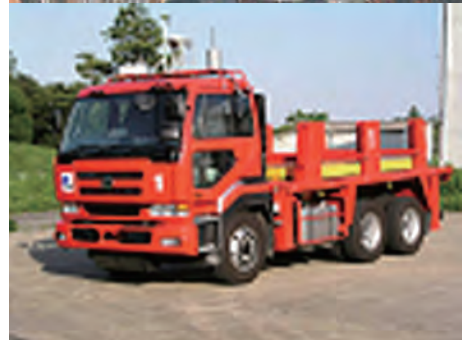
図-2.1.7.14 舗装走行実験場（上）と促進載荷用の荷重車（下）
