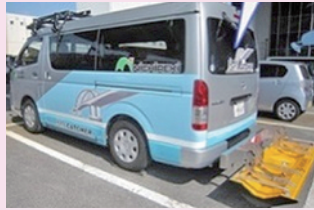
電磁波レーダーにより舗装面下の帯水層を見つけて床板の劣化を早期に発見する (CAESAR・物理探査)
