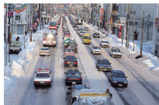
路面状況悪化に伴う速度低下による交通渋滞
