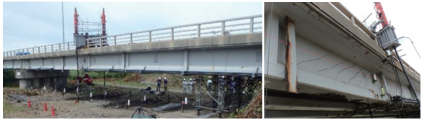
耐荷力評価手法の構築のため国内初の実橋PC主桁の破壊試験を実施（橋梁）
