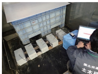
センサー機能を有する材料の実験 (中性化検知センサ)
