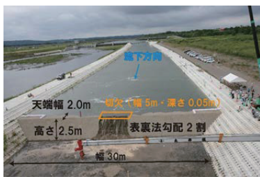
実物大規模の実験による 技術検討
