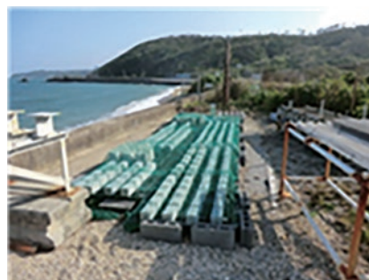
コンクリートの暴露試験実施状況
