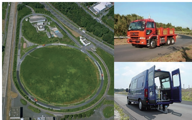
舗装の促進載荷実験と非破壊試験
