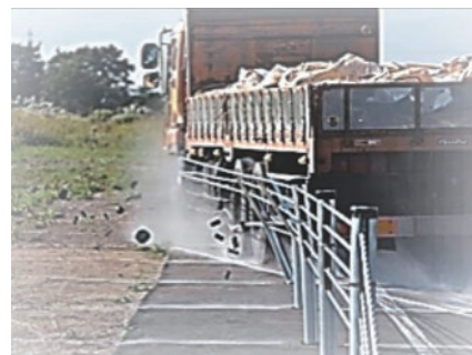
大型車による衝突実験
