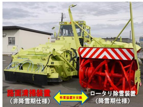
写真-2 開発した路面清掃装置
