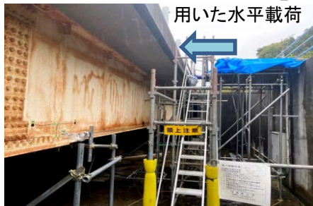
土木研究所内の試験橋梁を用いた载荷試験による橋の挙動計測
