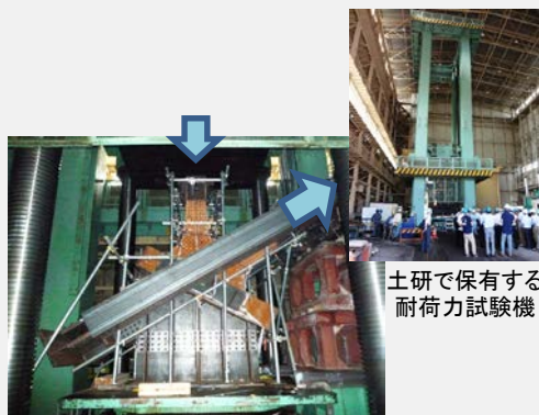
実橋梁部材（トラス格点）の破壊実験
