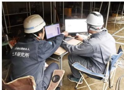
土木研究所内の試験橋梁を用いた载荷試験による橋の挙動計測
