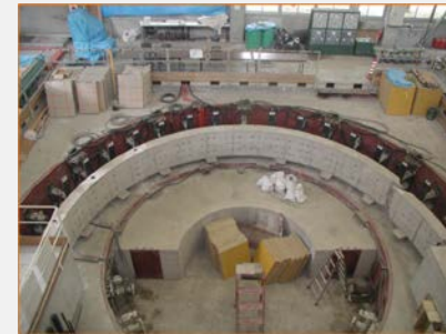
実物大覆工載荷実験
