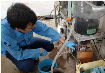
沈殿槽から汚泥を採取
