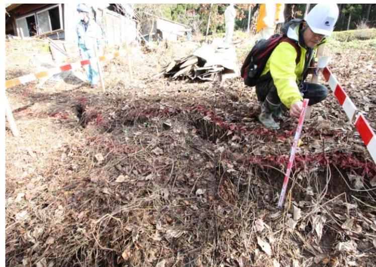
地すべりによって地表に生じた亀裂を測定する
