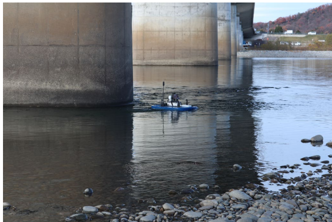
▲橋脚基礎洗掘点検ロボットの様子
