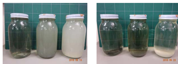
写真-3 固体硫黄の経時挙動
