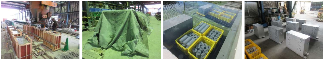
(A)コンクリート打込み (B)蒸気養生 (C)水中養生 (D)気中養生
