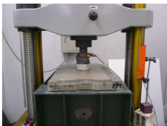
図-10 押し抜き試験の例
