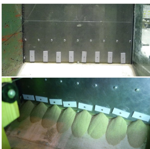
写真2 盛土材のこぼれ出し発生機構
