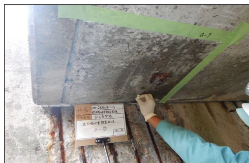
写真-10 測定状況 (ガーゼふき取り法)
