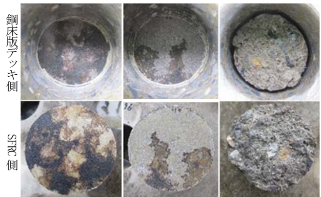
写真-5 試験位置毎のコアの破断面状況
