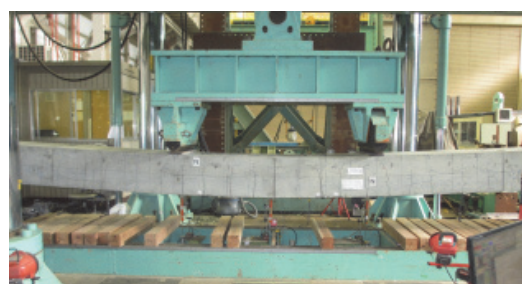
写真-3 載荷状況の例
