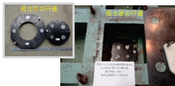
写真-1 掘削部の円蓋
