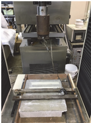
図3-3 引き剥がし試験の例
