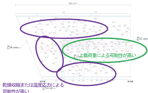
(a) 上載荷重によるひびわれおよび乾燥収縮または温度応力によるひびわれ
