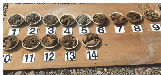
写真-1 掘削時に採取した土砂（数字：採取深度(m)）
