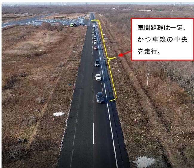
図-7 運転支援装置作動時の走行
