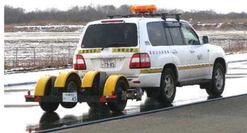
図-9 RT3-Curve（すべり測定車）
