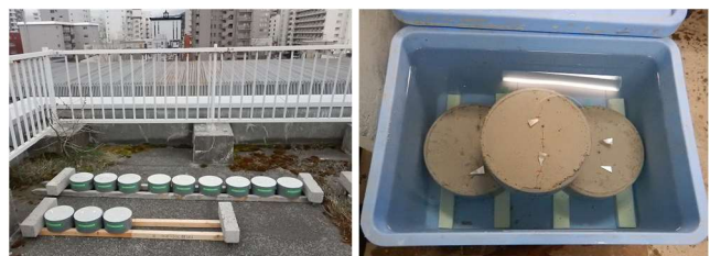
写真-3.2 ひび割れ供試体の暴露状況
