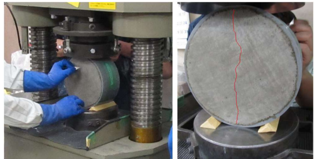
写真-3.1 ひび割れ導入状況(中央に割裂ひび割れ)
