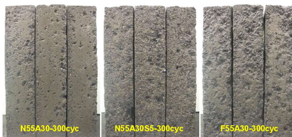
写真-3.7 凍結融解終了時の側面の状況 (ケース 3)
