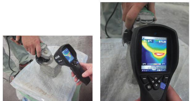
写真-8 赤外線カメラによるケレン時のディスクサンダーの刃の熱の測定状況
