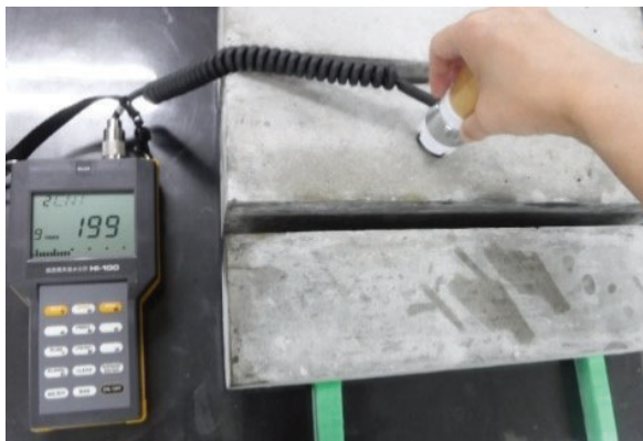
写真-5 電気抵抗式の水分計を用いた測定状況
