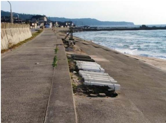
写真-6 ASR 供試体の暴露状況
