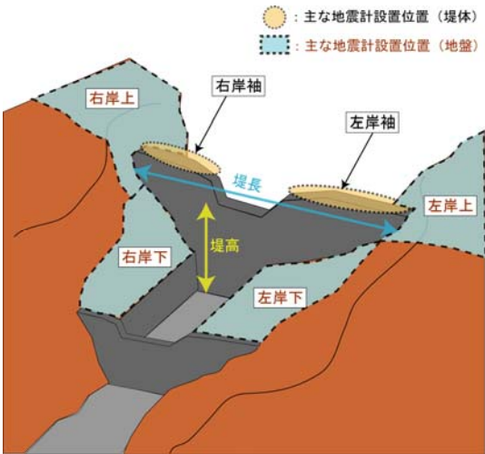
図-9 砂防えん堤の地震計設置概念図
