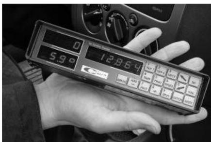
写真2 加速度計（フィンランドで使用している機器）
