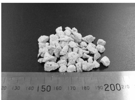
写真7 廃ガラス発泡骨材を利用したすべり止め材
