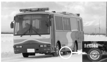
写真1 路面すべり測定車
