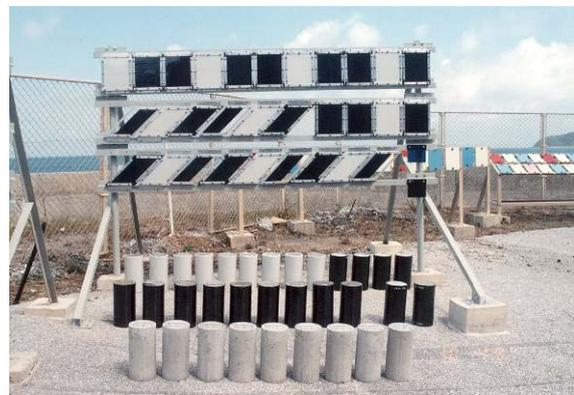
写真-7.2 CFRPシート供試体の暴露状況(大宜味)
