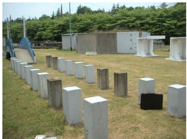
写真-5.1 ASR供試体の暴露状況
