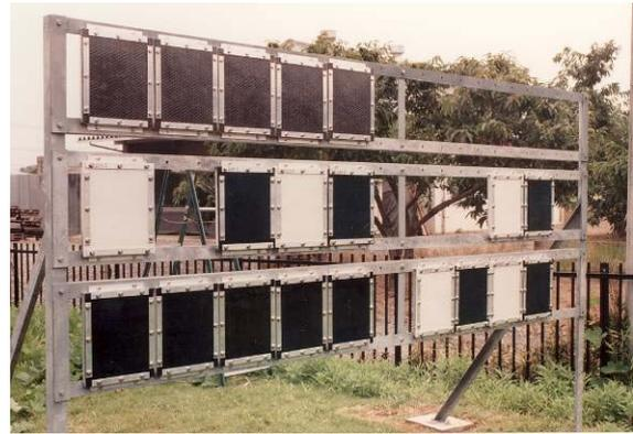
写真-7.1 CFRPシート供試体の暴露状況(つくば)
