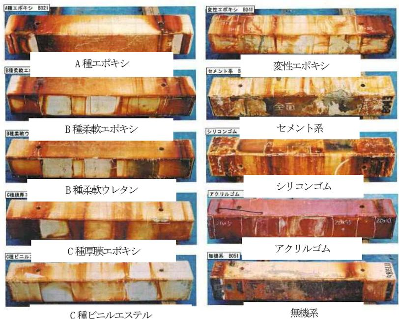
【表面の錆色は供試体固定枠によるもので、試験体から発錆したものではない】
