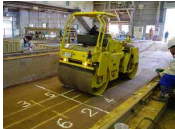
写真-6 振動ローラによる性能試験
