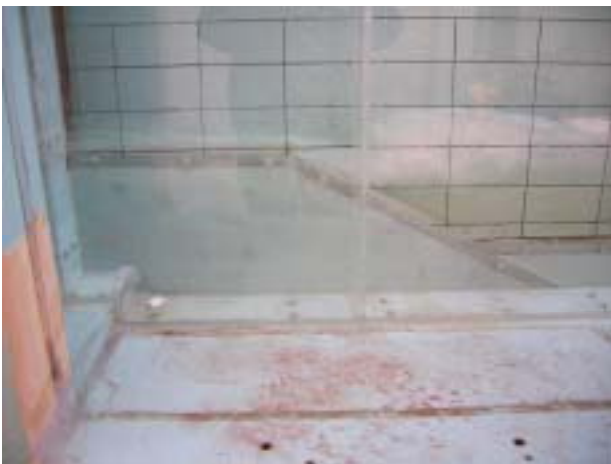
写真 - 3より、貯水位の上昇に従って、接続水路始端部から土砂が下流にフラッシュされて、減勢工底面まで達した後、下流に徐々にフラッシュされていき、最
