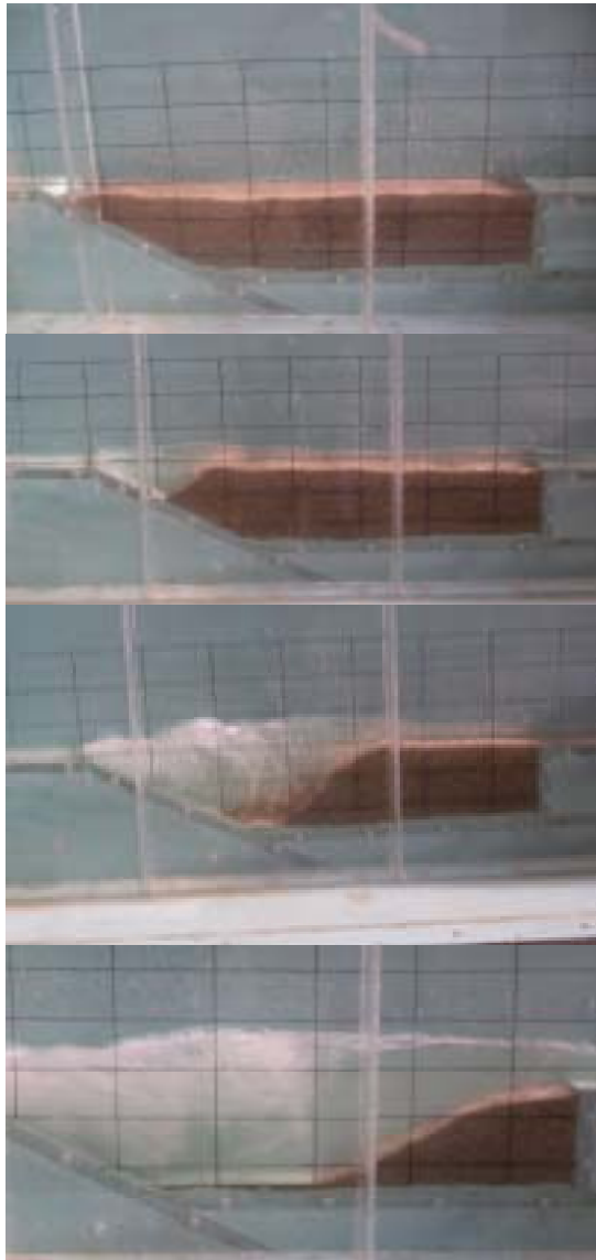
写真 - 3 減勢工満砂で貯水位上昇時の流況
