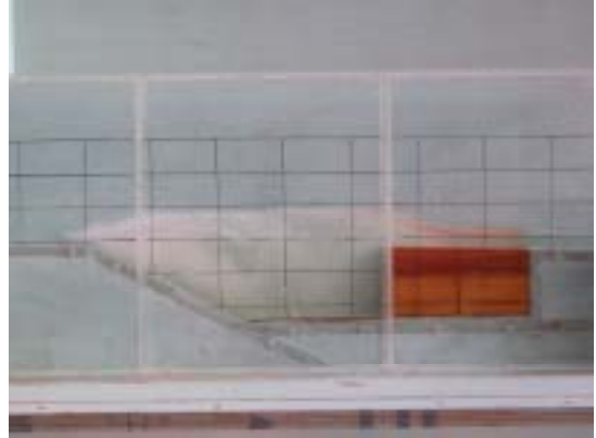
写真 - 5 減勢工満砂時水位上昇流況
