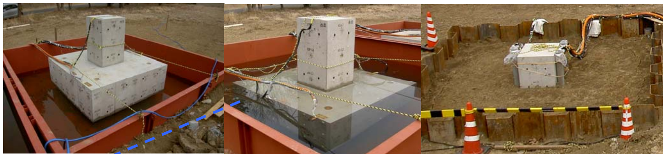
(b) Case 1: 水中養生, 水位変動 (c) Case 2: 水中養生, 常時水中 (d) Case 3: 土中埋設 写真-2.1 暴露状況写真 (暴露開始時, 2007/02/27)
