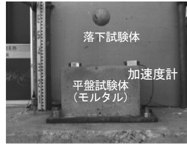
写真-I 室内実験状況（自由落下試験）
