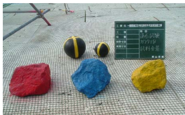
写真-III 現地実験の落下試験体
